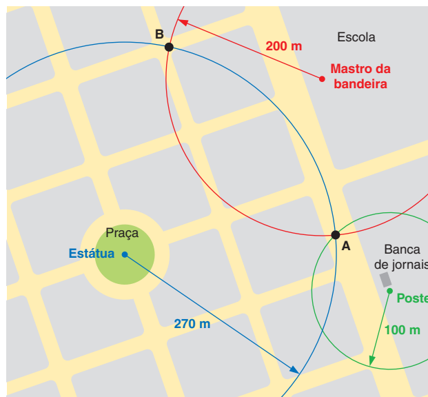
Analogia para determinação de coordenadas usando sinal GPS.
